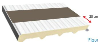
**PASO 4:** Verifique con atención las medidas de líneas guías de corte trazadas antes de proceder con el corte final.
