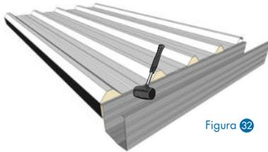
**PASO 3:** Fije el canal al panel utilizando tornillo A+ 2 1/2", 2 por cada valle del panel, asegurándose que también atraviese la pestaña del canal.
