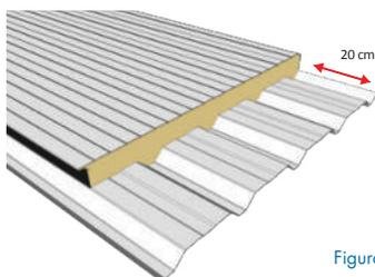
B. Si el corte no será para traslape longitudinal, sino que cortará por completo todo el espesor del panel, realice el corte con sierra circular cortando la espuma y ambas cubiertas metálicas del panel, en una sola pasada, siguiendo la línea guía. Si no le es posible cortar el espesor del panel en una sola pasada, corte parcialmente sobre cada cubierta metálica siguiendo la línea guía marcada en ambas caras del panel, hasta lograr el corte final deseado.
