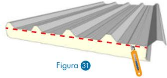
**PASO 2:** Inserte la pestaña interior del canal en la ranura en la espuma realizada en el paso 1, dando golpes suaves con un martillo de goma.
