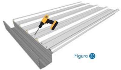
**PASO 4:** Complete la instalación de los canales, siguiendo las indicaciones en cada caso.
